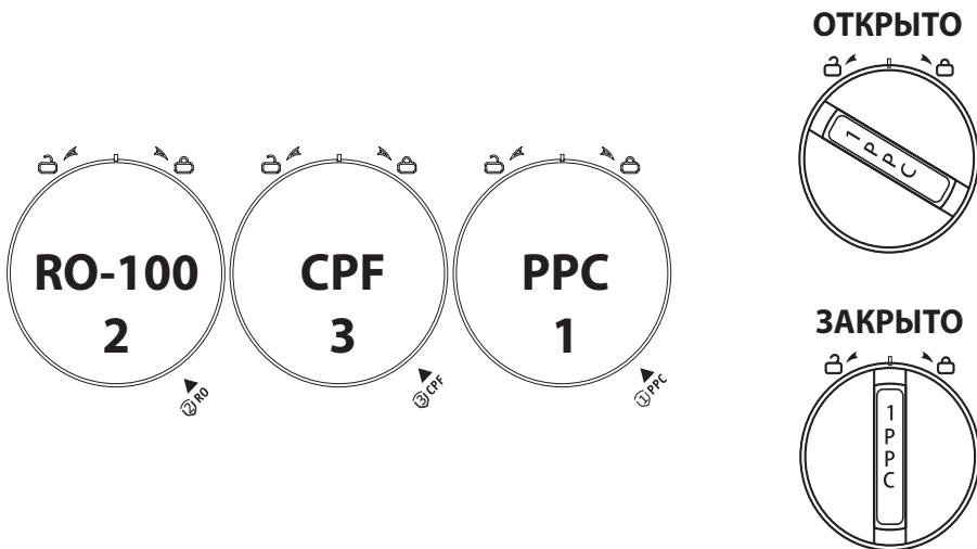
8. Откройте кран узла подачи воды в блок фильтрации.
