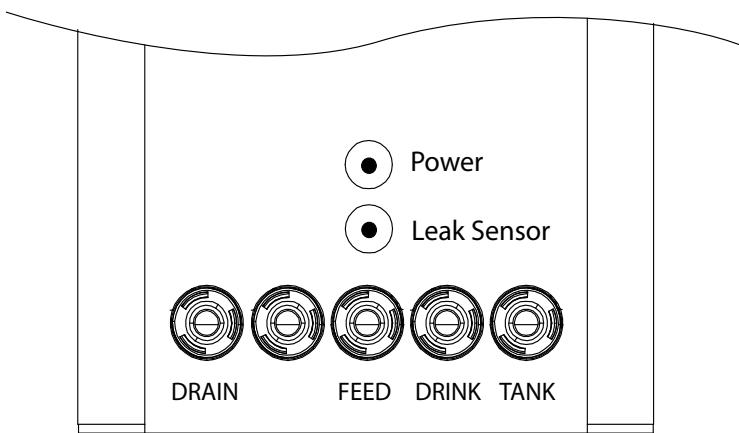
6. Подключите датчик протечки к блоку фильтрации в порт **Leak Sensor**.
