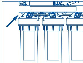
Поверните угловой фитинг вниз. Установите под фитинг вплотную к колбе ёмкость объёмом 4–5 литров. Медленно откройте вентиль на входе в водоочиститель приблизительно на треть поворота и промойте новые фильтроэлементы 3–4 литрами воды. Закройте вентиль, верните угловой фитинг в исходное положение и вставьте пластиковую трубку.
