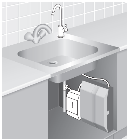
Рис.1. Пример установки фильтра Expert Osmos.
