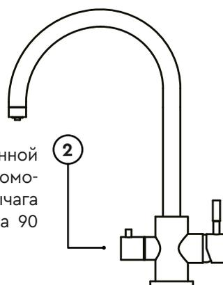
1 Пуск/закрытие и регулирование потока водопроводной воды, а также изменение ее температуры производится с помощью поворота правого рычага смесителя вниз/вверх и по горизонтали.
