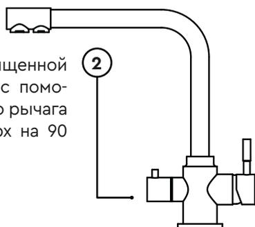
Пуск/закрытие и регулирование потока водопроводной воды, а также изменение ее температуры производится с помощью поворота правого рычага смесителя вниз/вверх и по горизонтали.
