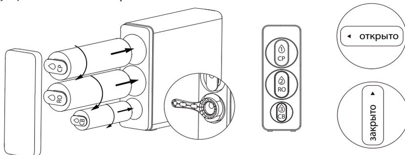
5. Порты для подключения трубок к блоку фильтрации располагаются сзади сверху корпуса блока. С помощью ключа для работы с быстросъемными соединениями извлеките заглушки **FEED, DRINK, DRAIN**. Красную заглушку не извлекайте.
